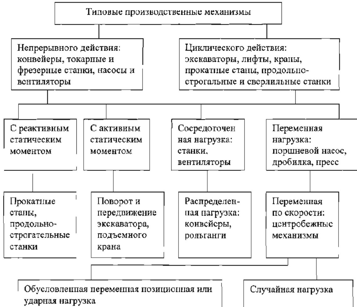
Рис. 3.1. Классификация типовых механизмов
