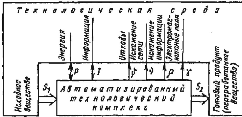
Рис.1. Схема взаимодействия автоматизированного технологического комплекса с технологической средой
